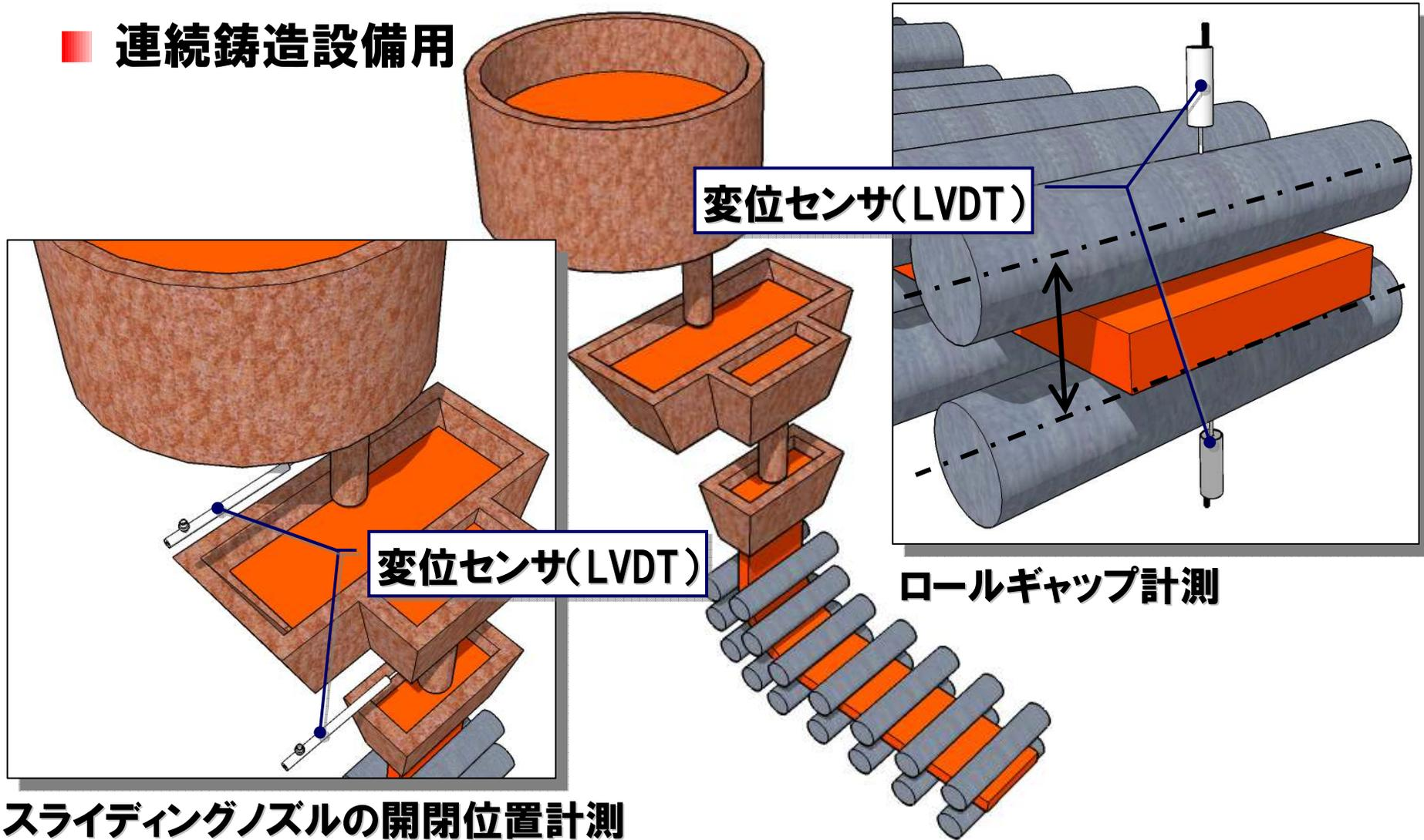
スライディングノズルの開閉位置計測
